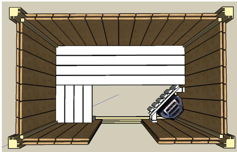
*Pianta sauna Elite 180x110, coibentata con sughero pressato*
